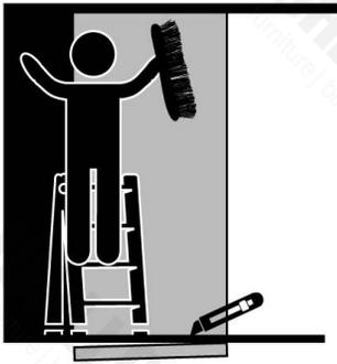
SPAZZOLARE DELICATAMENTE IL TELO DA SOPRA VERSO SOTTO E DAL CENTRO VERSO I LATI PER ELIMINARE BOLLE D'ARIA O ACCUMULI DI COLLA. ELIMINARE CON UNA SPUGNA UMIDA EVENTUALI ECCESSI DI COLLA AI MARGINI DEL TELO. A QUESTO PUNTO PROCEDERE CON IL RIFILO DELLE ABBONDANZE SOPRA, SOTTO E A SINISTRA UTILIZZANDO LA SPATOLA DA TAGLIO. ASSICURATI DI NON CREARE ABRASIONE SULLA PARTE SUPERFICIALE DELLA DECORAZIONE.
